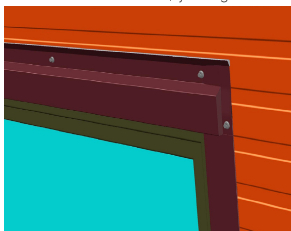
Vue 3D - Détail raccord linteau / jambage
